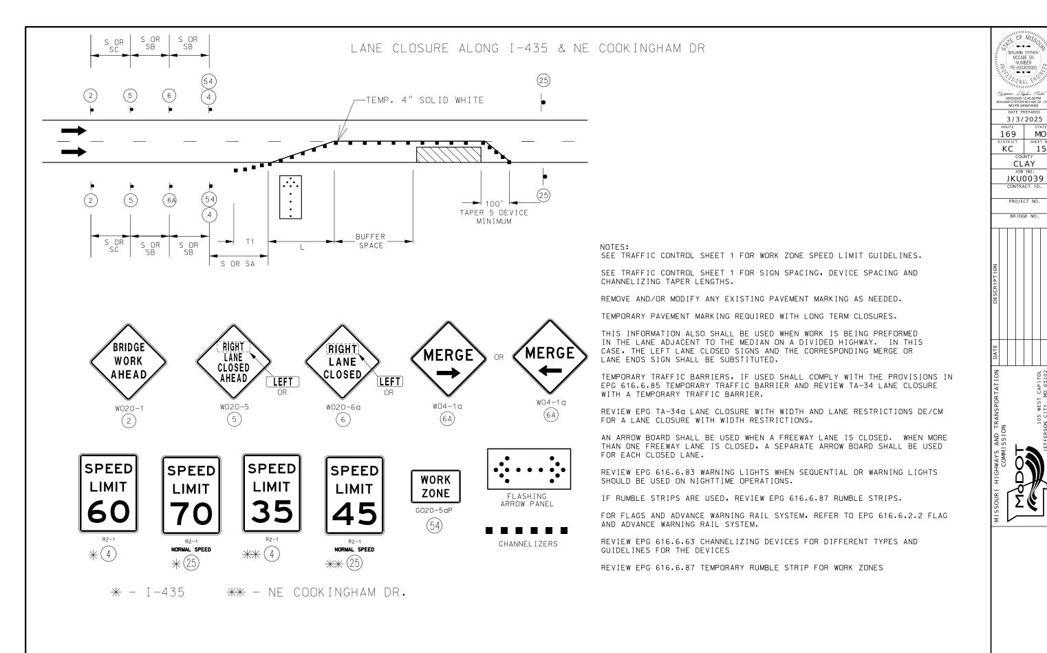
STATIONARY LANE CLOSURE ON DIVIDED & UNDIVIDED HIGHWAY TEMP. TRAFFIC CONTROL SHEET 12 OF 19
